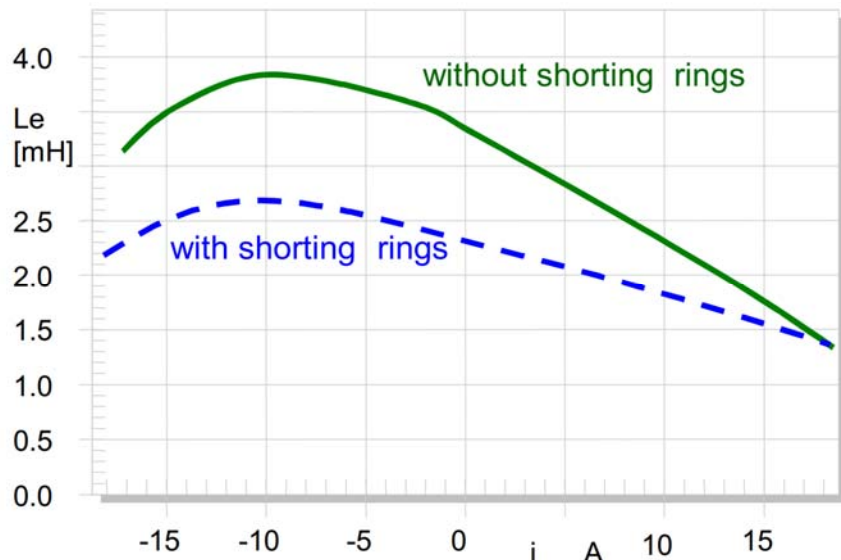
Imagen 10. Inductancia de la bobina L_e(i, x = 0) versus corriente en la bobina i con y sin anillo de cortocircuito magnético.
